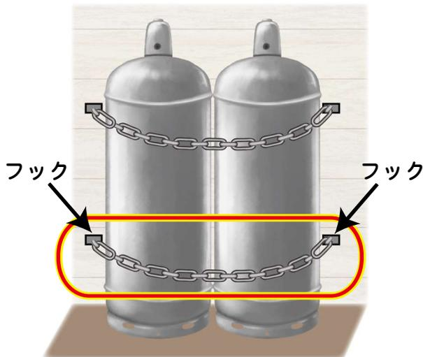
現状は1本のチェーンで固定されているお宅が多いため、追加でフックを外壁に固定させていただきチェーンを追加します。
